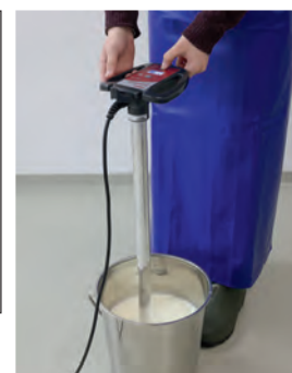
Heizfuß mit außen liegendem Temperaturfühler
